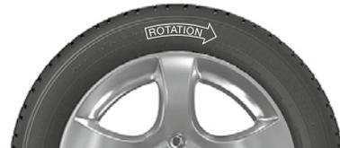
Beispiel einer Kennzeichnung der Laufrichtung
