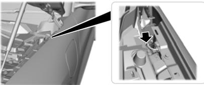
6. In der Lücke zwischen der Motorhaube und der Windschutzscheibe auf den manuellen Freigabemechanismus zugreifen und den Zugring kräftig quer in Richtung Fahrzeugmitte ziehen. Sicherstellen, dass sich die Zugschnur nach dem Ziehen nicht verheddert, da sie sich beim nächsten Ladevorgang zurücksetzt.
