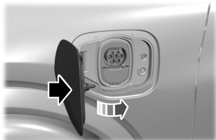
3. Zum Schließen die mittlere rechte Kante der Ladeanschlussklappe drücken.
